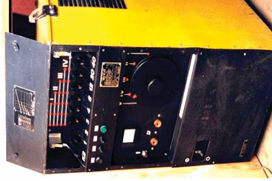
3.4.1 pav. Medžiagotyros ir suvirinimo katedros mokslininkų sukurtas universalus suvirinimo šaltinis VISI-A1 (1989)
