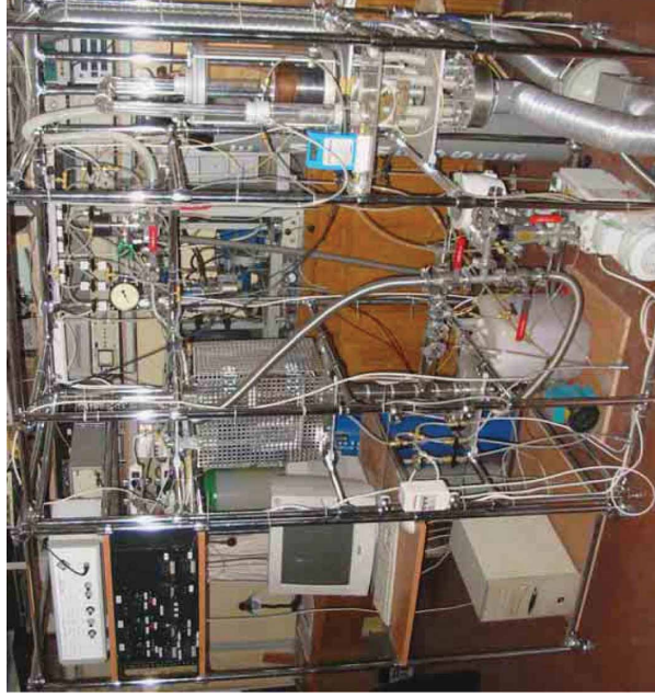
3.3.4 pav. Dviejų reaktorių sistema: kairėje – impulsinis – injekcinis MOCVD reaktorių, dešinėje – kombinuotas aerzolių pirolizės ir impulsinis – injekcinis MOCVD reaktorių įvairioms oksidinėms struktūroms nusodinti ant didelių padėklų (šiose reaktoriuose sukonstruota padėklų sukimo sistema)
