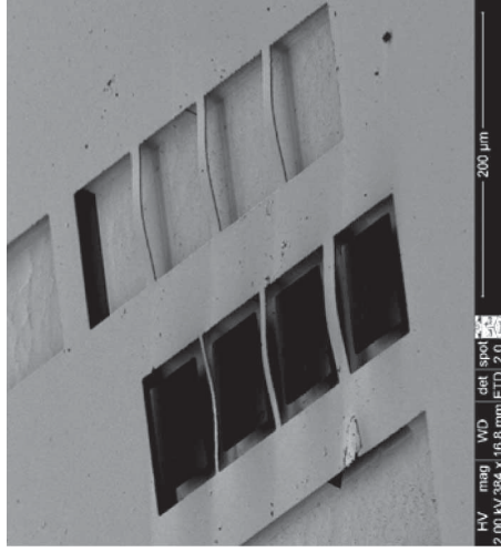
2.4.5 pav. Mikrostruktūros iš deimantškosios amorfinės anglies dangos, legiruotos \text{SiO}_x , su skirtingo pločio tiltais ant kristalino Si padėklo [3]
