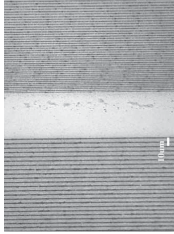
3.6.3 pav. Safyro padėklo precizinis rašavimas
