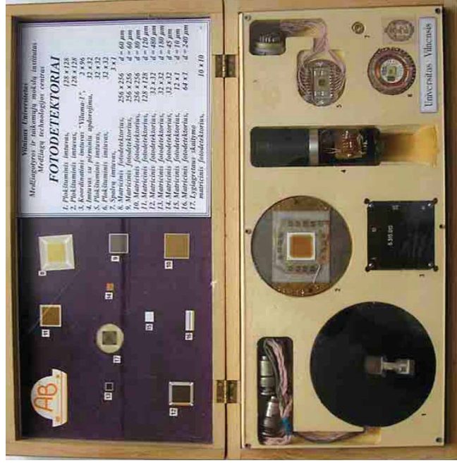
3.1.2 pav. VU daugiakanalių fotodetektorių pavyzdžiai tarp kurių seniausia fotoliniuotė sukurta 1967 m., o jauniausios gamintos iki 1990 m.
